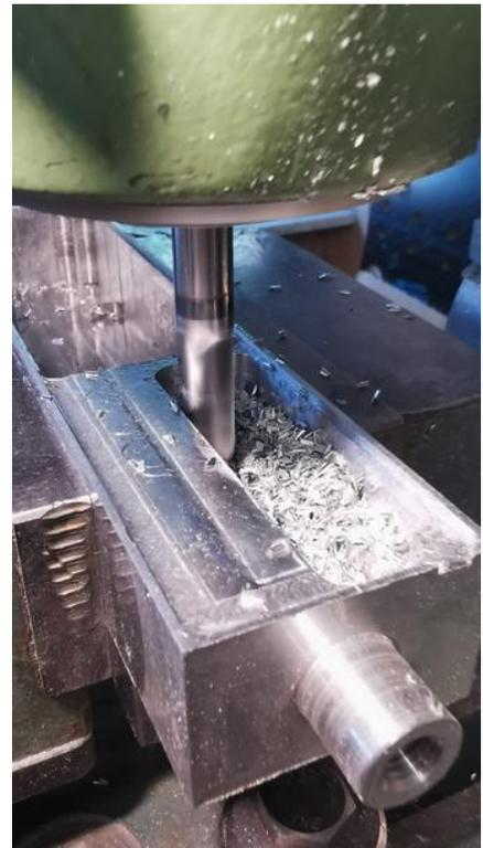
Jetzt geht es zur Sache! **Links**: der Rohling im Vierbackenfutter einer **Drehmaschine**, die Aufnahmen für Direktor und Reflektor werden ange dreht. **Mitte und Rechts**: Jetzt geht es auf die **Fräsmaschine** zum Schruppen und Feinbearbeiten.
