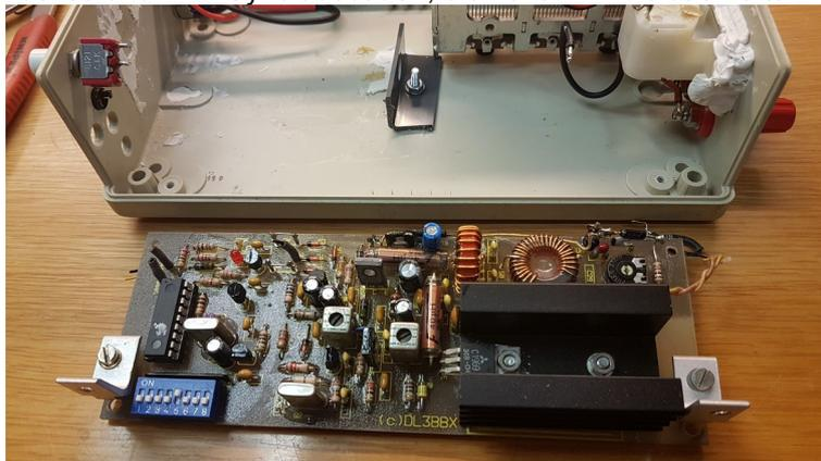
Nun wird der Digitalteil an der markierten Linie vorsichtig abgesägt:
