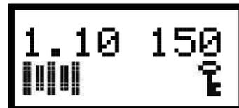
Im verriegelten Zustand sind alle oben beschriebenen Funktionen verfügbar, ausgenommen das Abschalten der Abschwächerautomatik. Hingegen sind alle Funktionen im unten beschriebenen Haupt- und Einstellmenü gesperrt.
