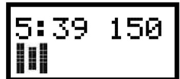
Durch Doppelklick auf den Drehgeber schalten Sie zur nächsten Frequenz weiter. Die aktuelle Frequenz wird durch die Zahl der Punkte nach der Fuchsnummer angezeigt, siehe die Beispiele rechts (Frequenz 2 und 4).
