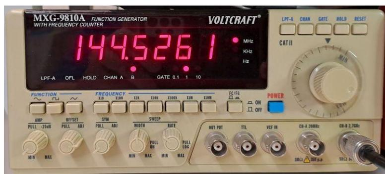
Einen Frequenzzähler braucht man bei der Empfängerentwicklung (wieso rastet die PLL schon wieder nicht), bei der Senderentwicklung (ist der ICS525 auf der gewünschten Frequenz?) und beim Synchronisieren der Fuchssteuerungen.
