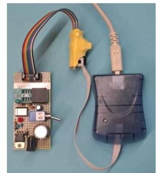
Um die Daten aus der .hex-File in den Atmel zu übertragen braucht es AVR Studio und einen ‚In System Programmer‘. Bei mir ist es ein ‚Atmel AVRISP Mk 2‘ →, der über USB an den Computer angeschlossen ist. Für die Programmier-Schnittstelle auf der Platine gibt es zwei Standards: 6-pin und 10-pin. Beides kommt bei mir vor. Siehe der Adapter im Foto. Den AVRISP2 gibt es nicht mehr, aber andere ebenso gut geeignete Programmer z.B. bei Reichelt.
