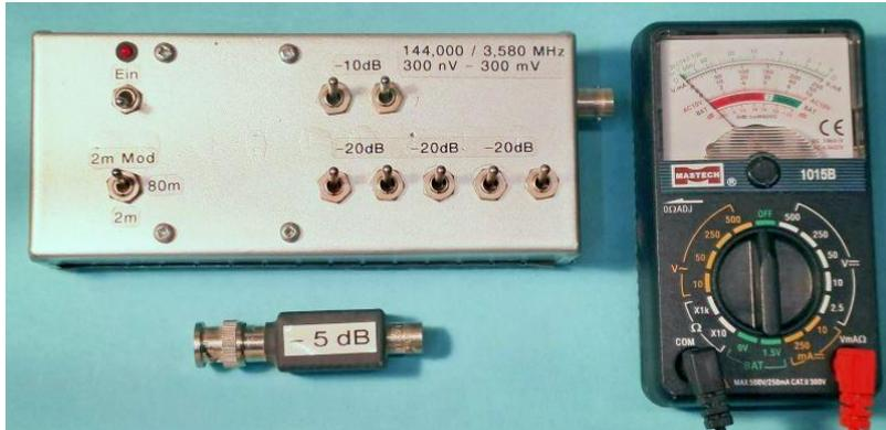
Und um meine **Empfänger abzugleichen** braucht man eigentlich nur die oben gezeigten Messmittel: den Testgenerator nach <http://www.df1fo.de/DOC/Testgenerator.doc>, ein zusätzliches 5 dB Dämpfungsglied, und ein analoges oder digitales Vielfachmessgerät.
