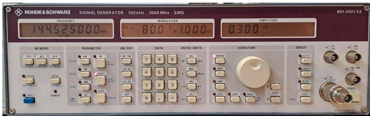
Auf eBay fand ich einen **Rohde&Schwarz SMG** in fragwürdigem Zustand für 450€. Die Konstruktion ist von etwa 1988, also 10 Jahre jünger als der SMS. Für mich ein wichtiger Vorteil: der Ausgangspegel kann mit einem Knopfdruck in 5 dB-Schritten variiert werden. Wer schon mal einen meiner SMD-Empfänger abgeglichen hat, weiß, warum das praktisch ist.
