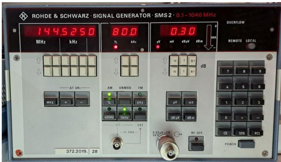
Und dies war dann meine neue Liebe: **Rohde&Schwarz SMS2**, ebenfalls aus Bundeswehr-Beständen, gekauft bei Rainer Förtig in seinem Lager nahe Darmstadt. Frequenz, Amplitude, Modulation werden über Drucktasten eingestellt, und Einstellungen können gespeichert werden. Das Herz ist ein Prozessor 8085A. Der SMS2 ist nur vier Jahre nach dem SMDU (oben) erschienen – aber von der Bedienung her etwa ein Lichtjahr moderner...
